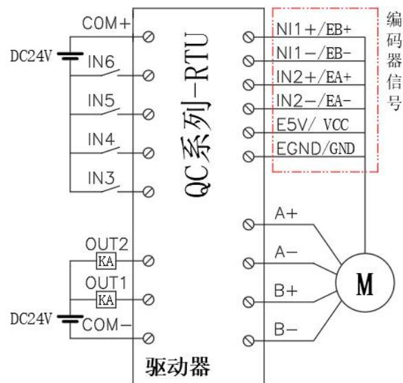
注：NI1、NI2必要时也可作脉冲输入仅支持5V信号，24V需串2K电阻。
