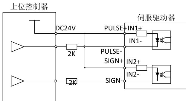
3、使用单端接法，外接通用输入信号，如点动正/反转信号：
