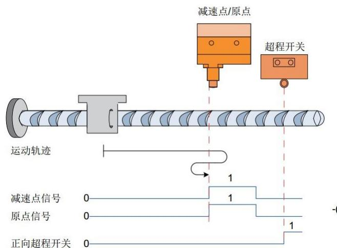
② 电机开始运行时原点开关(减速点)信号有效，全程未触发正向限位开关电机直接以-P290 设定值低速反向搜索减速点信号下降沿，遇到减速点信号下降沿则立即停机，后以 P290 设定值正向继续搜索原点信号上升沿，正向加速或正向匀速运行中，遇到原点信号上升沿立即停机。
